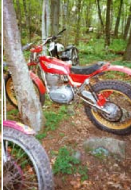
CCM Trial 1978, baserad på BSA B44/B50 men med motorn förminskad till 350cc som en BSA B40. Foto: JJ www.bsaoc.org
