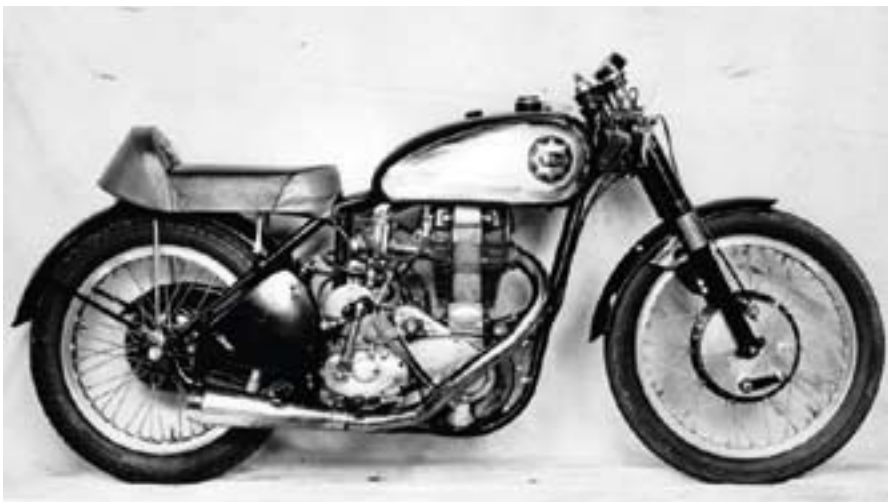
BSA Gold Star Racer från BSA:s satsning på Daytona 1954. Denna kördes av Tommy McDermott. Trots att svingarmsfjädring var standard byggdes dessa ändå om till stelben. BSA placerade sig på Daytona 200 mile Race den 7 mars 1954 på de fem första platserna med 4 st BSA Shooting Star (500cc twin) och denna 500cc stänka kom trea, alla med stel bakram. Foto: Morgan Johansson, www.britbike.com
